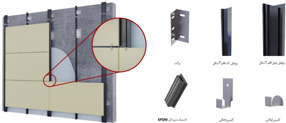
شکل ۷-۹- اجزای سیستم نصب نمایان
