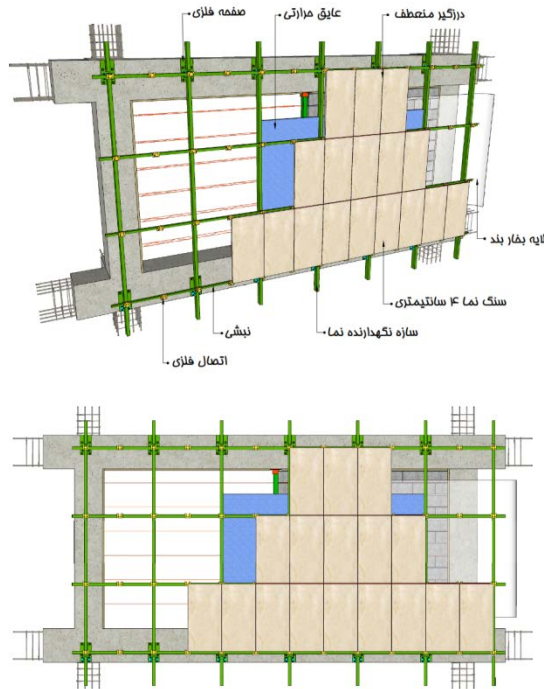
شکل ۴-۱۳- جزئیات اجرای نمای پرده‌ای سنگی
