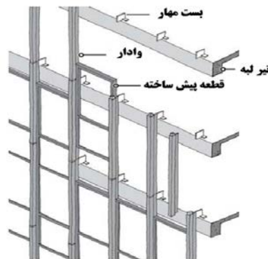
شکل ۹-۳- سیستم نمای پرده‌ای شامل قطعه-وادار
